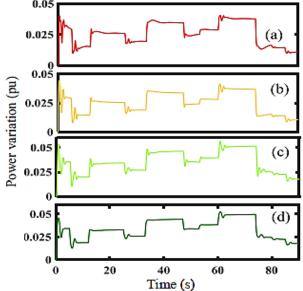
Fig. 8. Power variation of the generator (a) PSO-PID (b) SCA-PID (c) PSO-FOPID (d) SCA-FOPID
