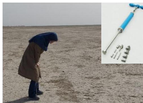
شکل ۲- اندازه‌گیری سختی سطح خاک با پنترومتر Figure 2- Soil surface strength measured by a handheld penetrometer
