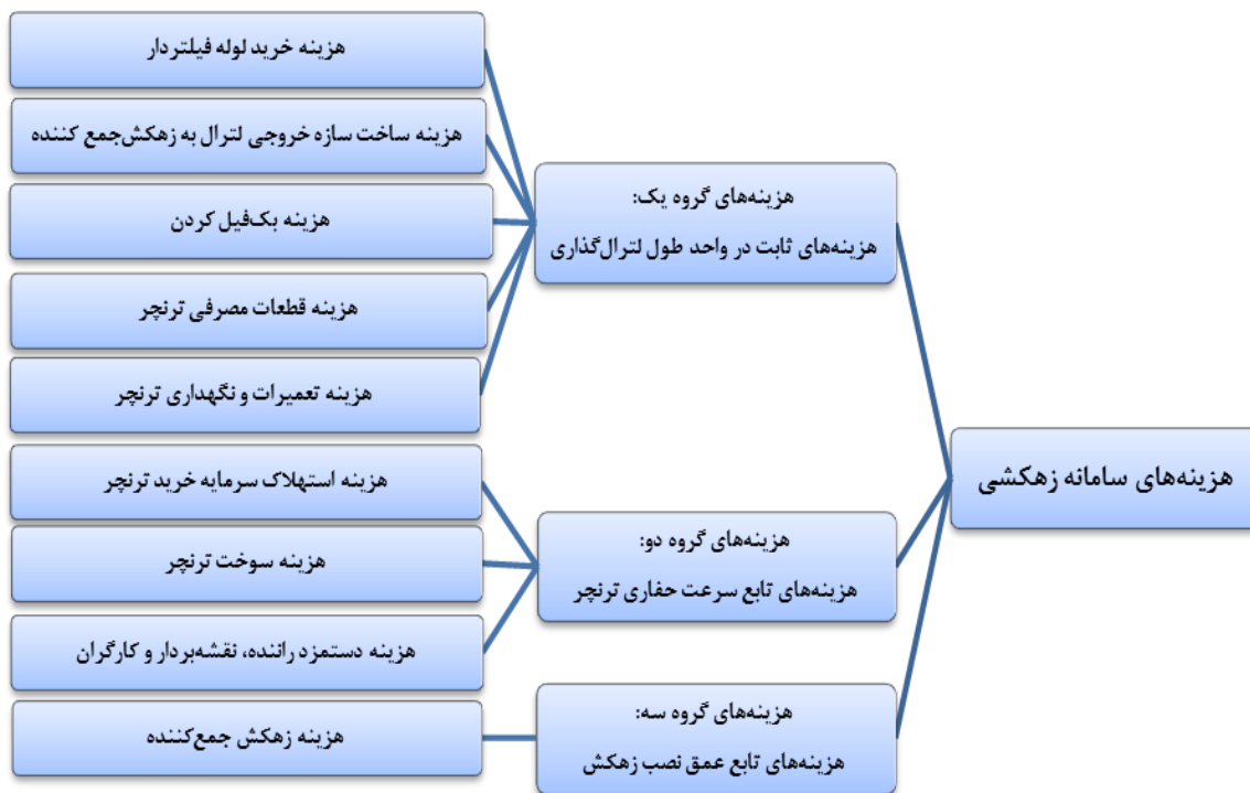
شکل ۱- هزینه‌های یک طرح سامانه‌ی زهکشی Figure 1- Costs of a drainage system design
