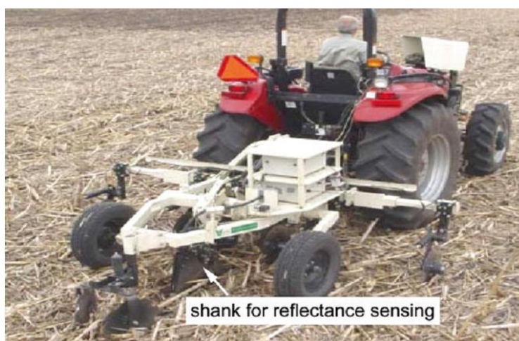
شکل ۵-۲۶ نقشه‌برداری همزمان بازتاب نزدیک فروسرخ در زیر تیغه کولتیواتور و رسانایی الکتریکی در حالت تماسی (Veris Technologies, Salina, USA)
