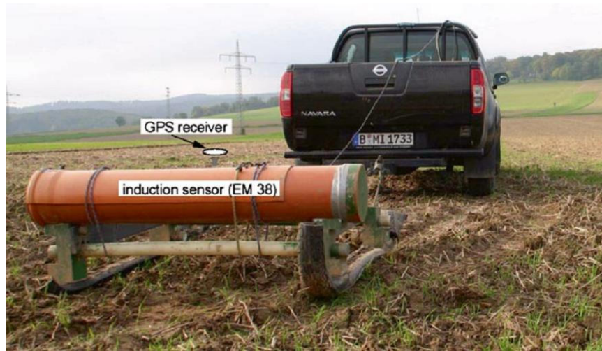
شکل ۴-۵ سنجش آنلاین و در حال حرکت هدایت الکتریکی به روش القای الکترومغناطیس (EM 38 of Geonics LTD, Canada)
